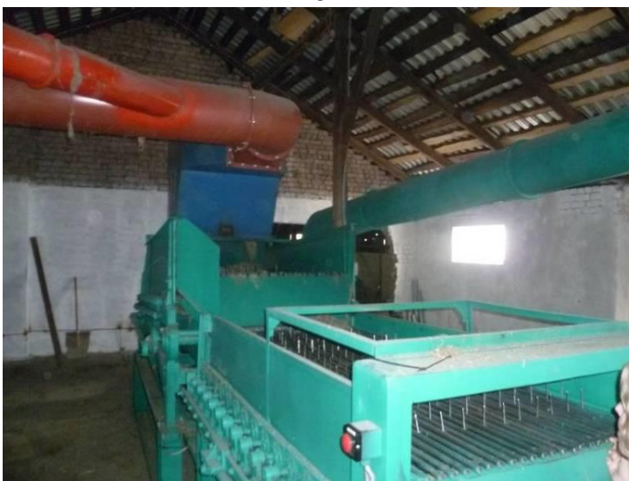
Рис. 4. Общий вид отдельных машин линии: а – дезинтегратор ДЛВ-2; б – разгрузитель Левитского; в – трясильные машины
