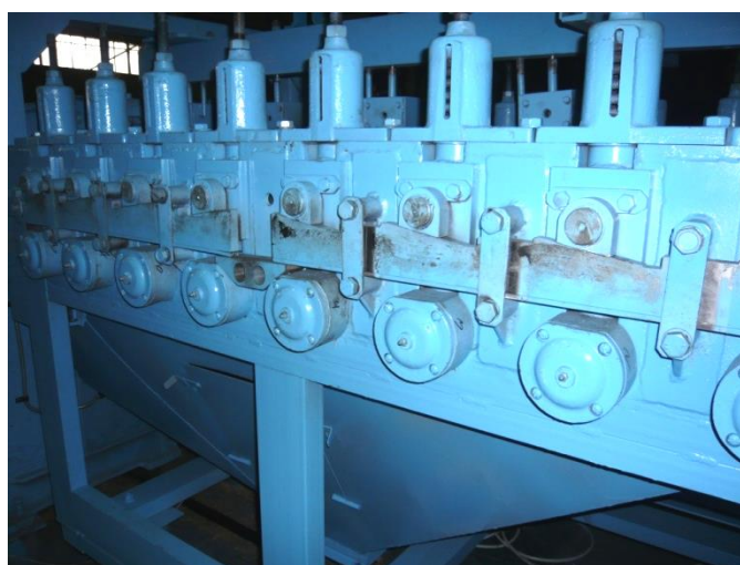
Рис. 22. Узел для изменения глубины захождения рифель в процессе промина
