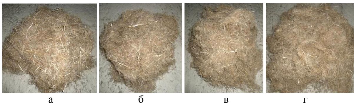
Рис. 6. Вид короткого волокна из соломы после различного числа пропусков через линию:
