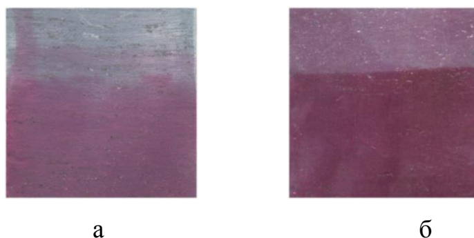
Рис. 8. Влияние влажности поверхности оксидной плёнки на результат адсорбционного окрашивания: а – влажная, б – сухая поверхность
