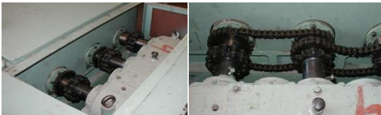
Рис. 6. Узлы привода для дискретного изменения числа зон утонения; варианты со степенью утонения: а – 11,6; б – 6,5
