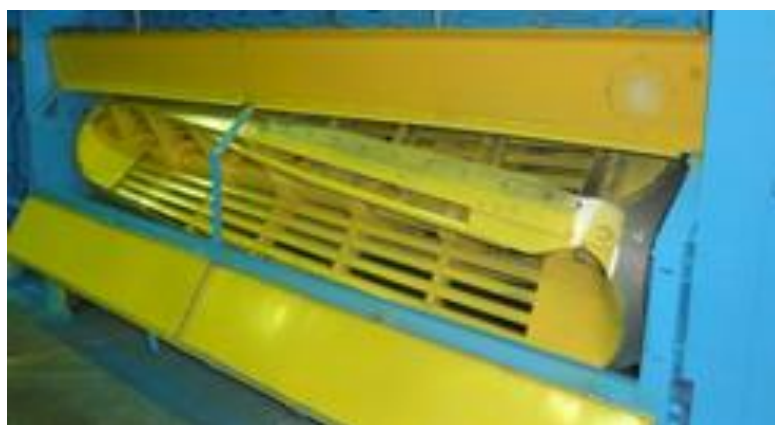
Рис. 34. Трепальные барабаны для секций: а – для первой и третьей; б – для второй и четвёртой
