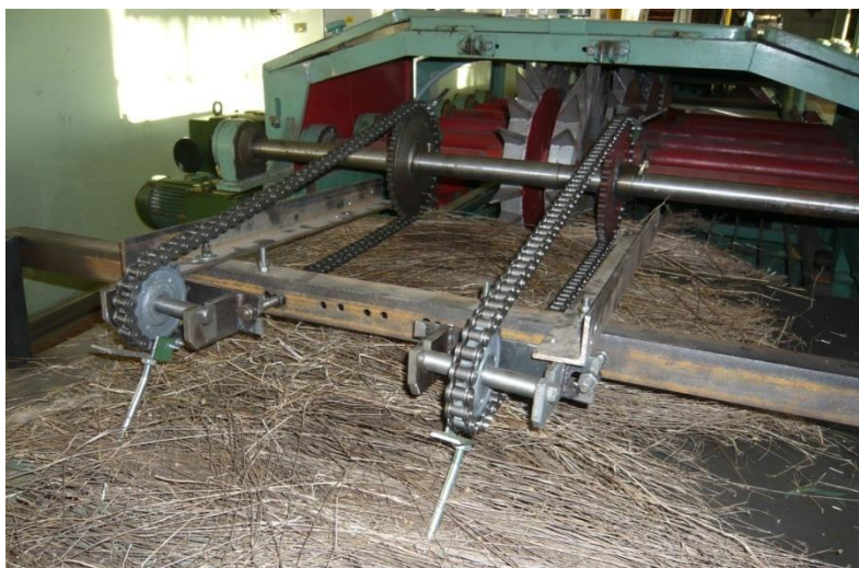
Рис. 7. Узел для принудительного снижения угловой дезориентации
