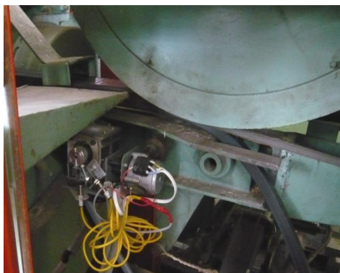
Рис. 30. Узел изменения положения вилки двойного протрепа в зоне перехвата прядей льняного сырца между секциями трепальной машины
