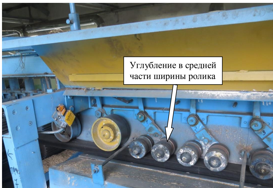
Рис. 27. Прижимные ролики усовершенствованной конструкции
