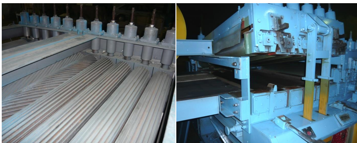
Рис. 20. Рабочие органы мяльной машины М-110-Л2
