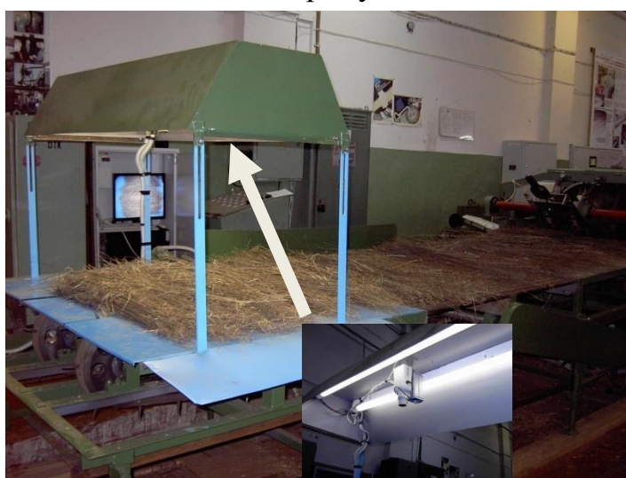
Рис. 7. Узел для принудительного снижения угловой дезориентации
