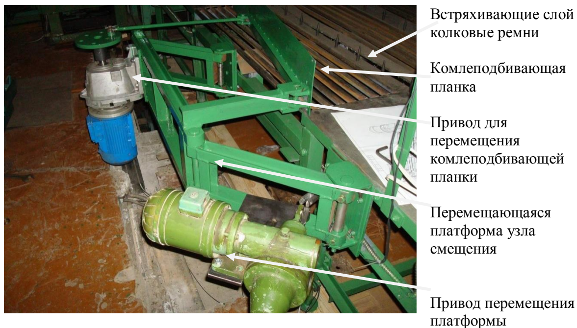
Рис. 4. Узлы для встряхивания слоя копковыми ремнями и для смещения слоя в процессе его комлеподбивания
