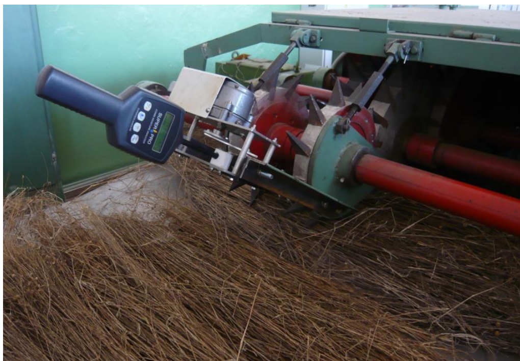
Рис. 32. Средство контроля влажности тресты в процессе перемещения слоя
