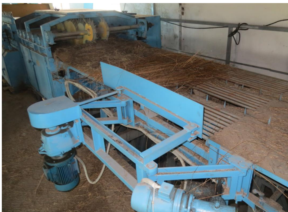
Рис. 10. Слоеформирующая машина агрегата МТА-3Л с узлом комлеподбивания и смещения слоя
