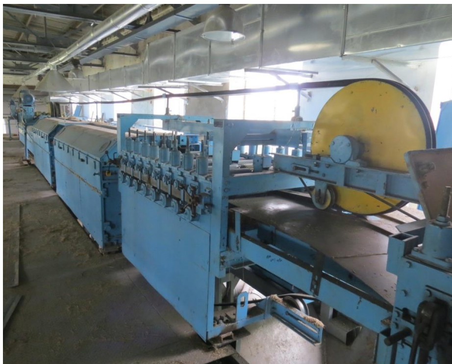
Рис. 37. Новый мяльно-трепальный агрегат МТА-3Л в цеху Даниловского льнозавода (вид: начиная с последней секции мяльной машины и четырёхсекционная трепальная машина)
